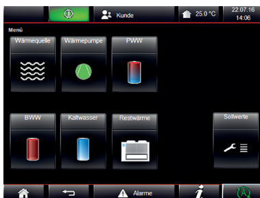
Einfach zu bedienende SPS-Regelung mit Farb-Touch-Display
