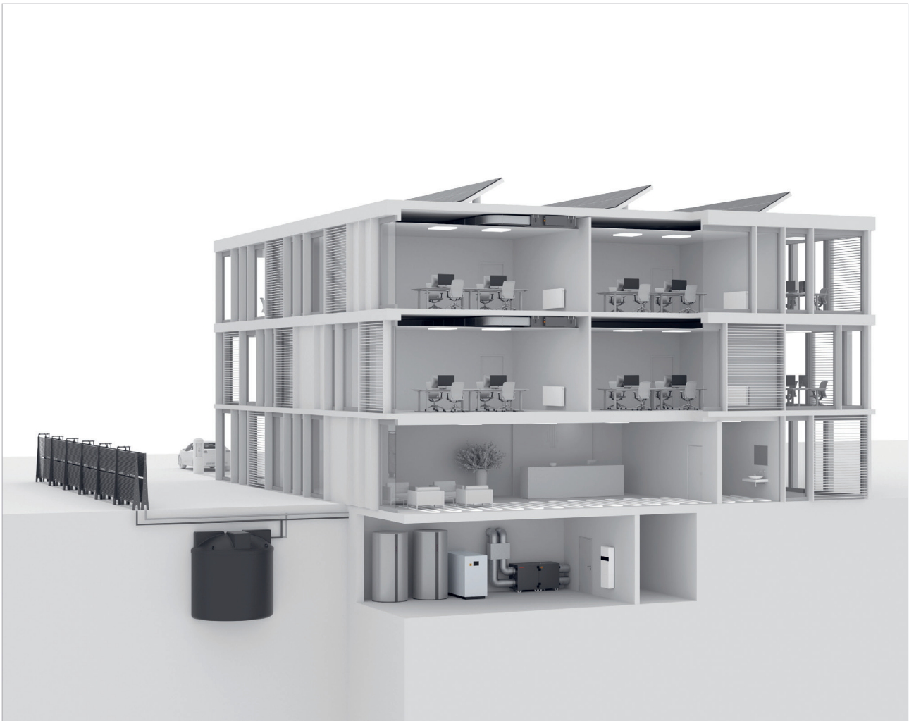
Sole/Wasser-Wärmepumpe Vitocal 350-G PRO mit Eis-Energiespeicher
