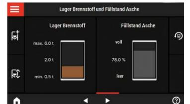
Ecotronic Touch - Anzeige Brennstofflager und Aschefüllstand
