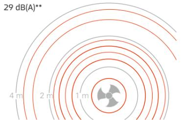
\*\* Bezogen auf den ErP-Punkt C der 4 kW Wärmepumpe mit 46 dB(A) Schalleistung ergibt sich ein Schalldruck von 29 dB(A) bei Aufstellung der Außeneinheit in 4 m Abstand zur Hauswand.
