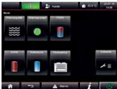
Einfach zu bedienende SPS-Regelung mit Farb-Touch-Display
